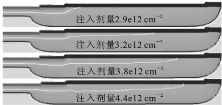
图 11 不同注入剂量的 JTE 区耗尽层对比
